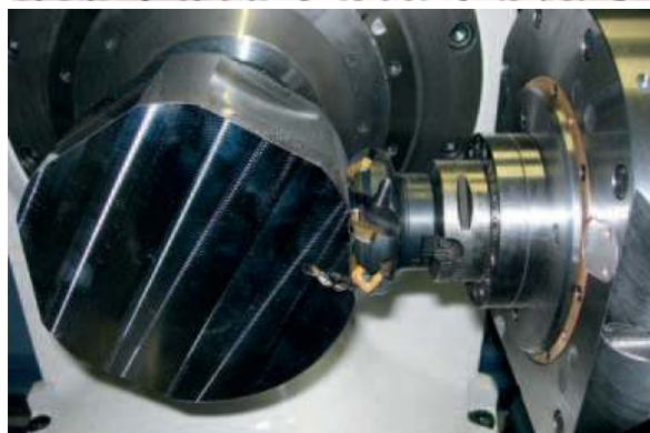
L’impianto faro realizzato da MCM per processo di fresalesatura e tornitura di particolari critici in acciaio e titanio per il settore aerospaziale.
